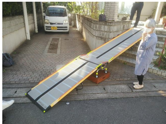
簡易スロープを6段の階段 に設置＋アシスト型車い す
